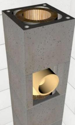
Наносим раствор М150 на уже смонтированный блок, монтируем следующий блок, убираем излишки раствора. Монтируем каменную вату, стыки каменной ваты должны быть на середине стенки блока, лишнюю каменную вату обрезаем. Проверяем уровнем.
