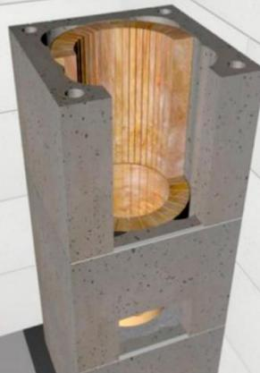
Монтируем каменную вату, оставляем отверстия для передней части тройника ревизии.
