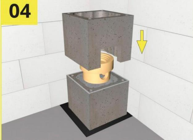
Устанавливаем предварительно подготовленный блок с отверстием для решётки конденсатосборника. Проверяем уровнем.
