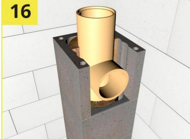
Очищаем влажной губкой керамические поверхности, наносим готовую смесь на керамическую поверхность, монтируем тройник подключения на трубу, удаляем излишки смеси влажной губкой. Тройник ревизии должен совпасть с пазами на трубе. Проверяем уровнем.
