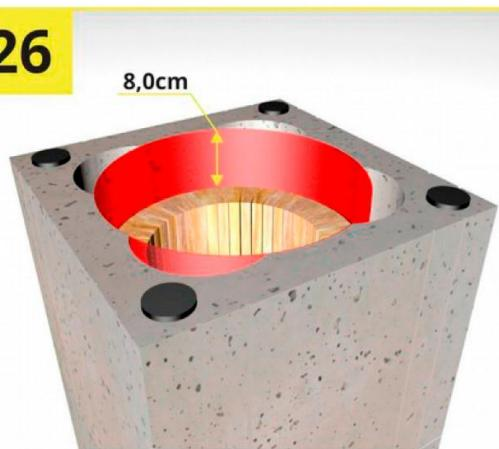
В последнем блоке каменная вата монтируется с отступом 8 см от верхнего края блока, это необходимо для внутренней вентиляции дымохода.
