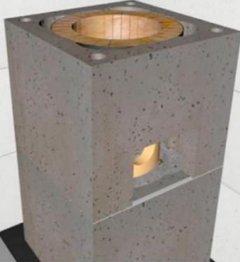
Монтируем каменную вату. Стыки каменной ваты должны быть на середине стенки блока, лишнюю каменную вату обрезаем по верхнему краю блока.
