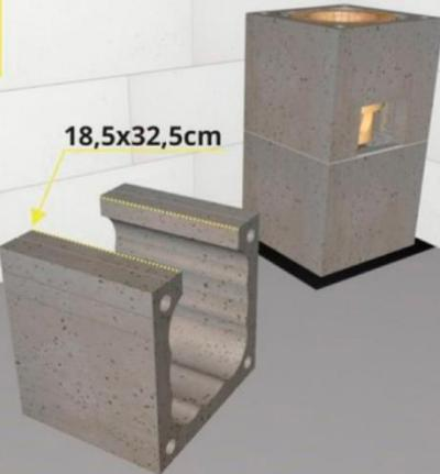
В блоке, согласно канавок, выпиливаем отверстие для тройника ревизии (18,5 см). Для отверстия можно использовать готовый шаблон (входит в расширенный пакет "MAX"). Проверяем уровнем.
