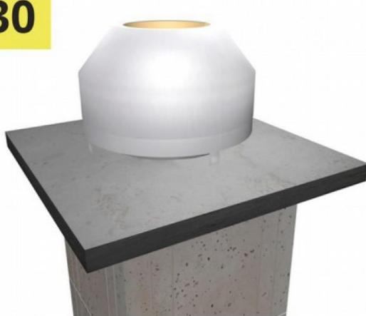
После монтажа конуса необходимо удалить ткань П.12, установить решётку конденсатосборника П.5, установить дверце тройника ревизии П.10. Использование Дымохода возможно через 7 дней после окончания монтажа.
