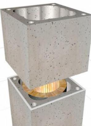
Наносим раствор М150 на уже смонтированный блок, монтируем следующий блок, убираем излишки раствора, Монтируем каменную вату стыки каменной ваты должны быть на середине стенки блока, лишнюю каменную вату обрезаем. Проверяем уровнем
