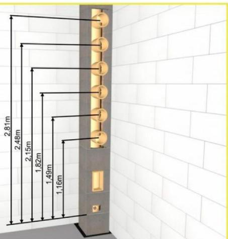
Определяем высоту и направление подключения теплогенерирующего аппарата. Минимальная высота монтажа тройника подключения 1,16 м. Установите необходимое количество блоков, керамической трубы и каменной ваты до необходимой высоты монтажа тройника подключения. Проверяем уровнем.
