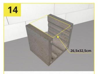
Выпиливаем отверстие для тройника подключения 26,5 см, следует использовать часть за внешними полосками на блоке. Для отверстия можно использовать готовый шаблон (входит в расширенный пакет"МАХ").
