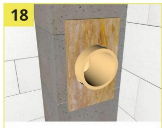
Монтируем переднюю панель из каменной ваты на тройник подключения, внутренний размер вырезается по шаблону под необходимый размер. Для монтажа передней панели используют крепления (входит в расширенный пакет"МАХ").
