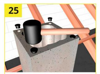
Чтобы произвести дополнительное армирование дымохода, следует на необходимой высоте (см. выше п.№14 «Информация по установке») установить заглушки для шпилек (арматуры). Далее монтируются детали дымохода, в отверстия по углам блока вставляются метровые куски шпильки либо арматуры ф8/ф10 и проливаются раствором М150-М300 на всю глубину.
