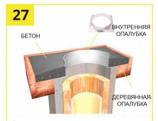
В случае самостоятельного изготовления покровной бетонной плиты опалубка монтируется в верхней части дымохода. Перед заливкой бетоном М150 устанавливается подставка под бетонную плиту (входит в комплетк поставки). Толщина бетонной плиты должна быть не менее 4,5 см, а габариты на 7-8 см больше габаритов блока.
