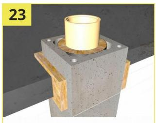
При прохождении дымохода через перекрытия необходимо осталвять зазор: от 0,5-1 см в бетонных перекрытиях, 5-10 см в дереянных перекрытиях. Полученное пространство заполняется негорючим материалом (каменная вата). Проверяем уровнем.
