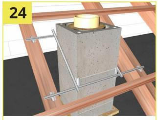
При проходе через кровлю необходимо зафиксировать дымоход, оставляя зазор между блоком и элементом крепления 0,5 - 1 мм. Проверяем уровнем.
