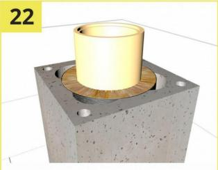
Очищаем влажной губкой керамические поверхности, наносим готовую смесь на поверхность керамической трубы и удаляем излишки смеси влажной губкой. Пазы труб должны совпасть. Проверяем уровнем.
