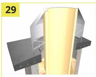
Верхняя керамическая труба должна выступать над бетонной плитой для монтажа конуса дымохода. Конус дымохода имеет регулировку по высоте. Верхняя часть керамической трубы должна быть ровной, место примыкания трубы к конуса дымохода необходимо промазать огнеупорным герметиком.
