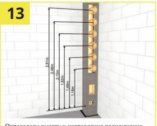
Определяем высоту и направление подключения теплогенерирующего аппарата. Минимальная высота монтажа тройника подключения 1,16 м. Установите необходимое количество блоков, керамической трубы и каменной ваты до необходимой высоты монтажа тройника подключения. Проверяем уровнем.
