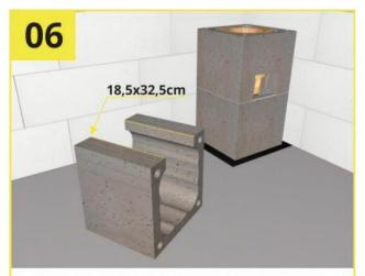
В блоке, согласно канавок, выпиливаем отверстие для тройника ревизии (18,5 см). Для отверстия можно использовать готовый шаблон ( входит в расширенный пакет "МАХ"). Проверяем уровнем.
