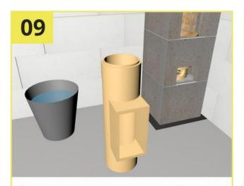
Очищаем поверхность конденсатосборника и нижнюю часть тройнка ревизии влажной губкой (входит в расширенный пакет "МАХ"), наносим подготовленную смесь на тройник ревизии.
