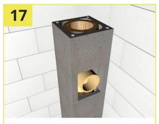
Наносим раствор М150 на уже смонтированный блок, монтируем следующий блок, убираем излишки раствора. Монтируем каменную вату, стыки каменной ваты должны быть на середине стенки блока, лишнюю каменную вату обрезаем. Проверяем уровнем.
